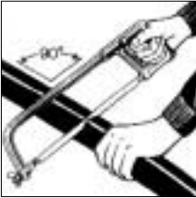
1. PE-Rohr rechtwinklig ablängen
